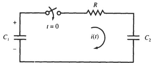
**Fig. 3-21** RC circuit.
