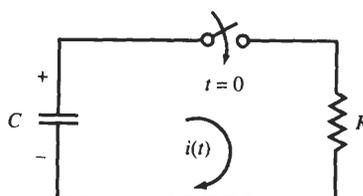
**Fig. 3-20**  $RC$  circuit.
